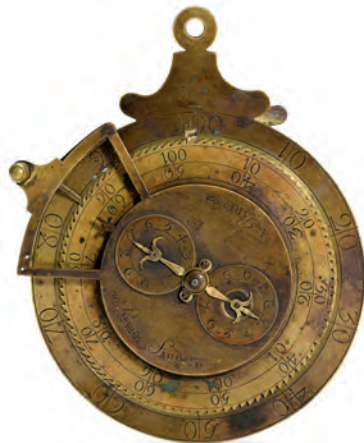
P. Fardoil zsebóra-formájú számológépe, 1710-ből
